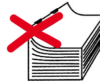
Papier zu dünn - Klammerung trägt auf
